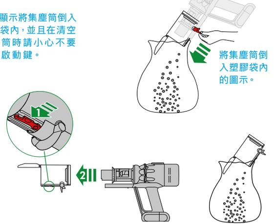
將集塵筒倒入塑膠袋內的圖示。
