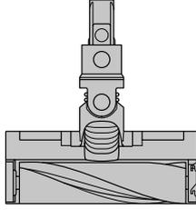
軟質碳纖維滾筒刷條位於吸頭內。電子連接器末端可連接至延長管末端或直接連接至機器。
