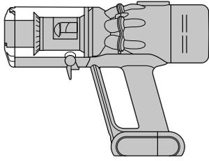
吸塵器主體顯示已安裝手柄和集塵筒。
