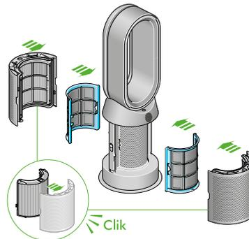
三合一甲醛偵測涼暖空氣清淨機濾網蓋打開，顯示位於濾網蓋的二合一 HEPA+ 活性炭濾網，以及催化濾網。箭頭顯示催化濾網直接安裝到機器底座，且濾網蓋需組裝到機器底座上。
