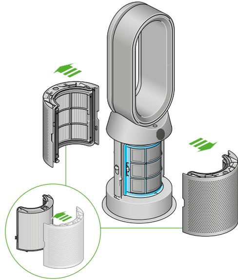
三合一甲醛偵測涼暖空氣清淨機濾網蓋打開，顯示位於濾網蓋的二合一 HEPA+ 活性炭濾網，以及催化濾網。箭頭顯示催化濾網直接安裝到機器底座，且濾網蓋需組裝到機器底座上。
