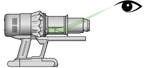
從無線吸塵器上取下延長管後，檢查延長管兩端是否堵塞。
