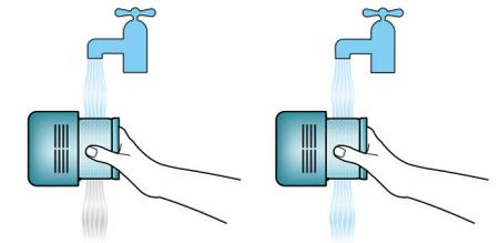
一手握住濾網，窄端朝下，甩出濾網中的水，然後再次將末端朝下，將水甩出。
