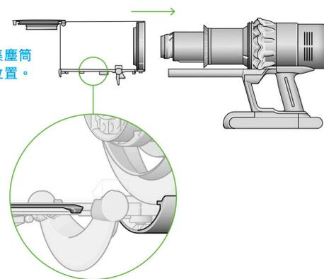
集塵筒滑回滑軌上的正確位置時，集塵筒底座亦會關閉。
