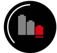
附帶大、中、小三個電池圖示的警示。前兩個灰色代表電力耗盡。第三個是紅色，表示電池電量極低。
