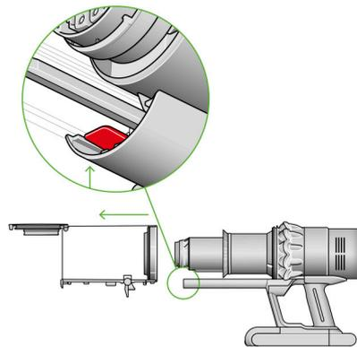
集塵筒推回到集塵筒滑軌上的正確位置。
