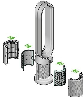
二合一空氣清淨機濾網蓋打開，顯示位於濾網蓋的 HEPA 濾網，
