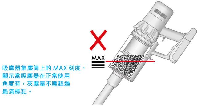
吸塵器集塵筒上的 MAX 刻度，顯示當吸塵器在正常使用角度時，灰塵量不應超過最滿標記。
