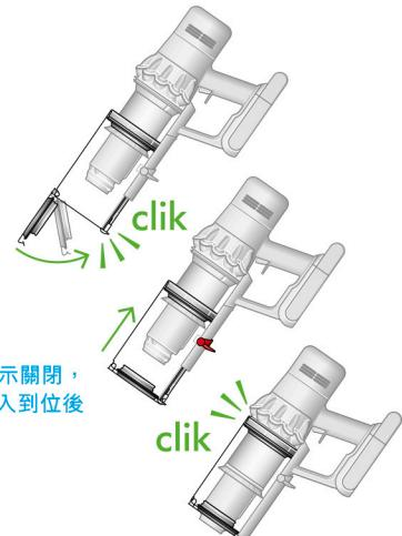
集塵筒蓋發出咔嗒聲表示關閉，集塵筒向上推至完全卡入到位後再次發出咔嗒聲。
