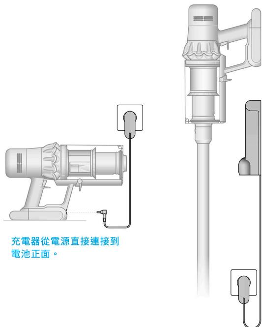
充電器從電源直接連接到電池正面。
